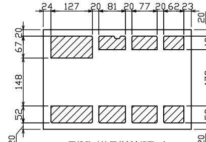
配線孔寸法図(フロント部開口)
