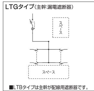
**単3** 主幹：単3中性線欠相保護付 漏電遮断器・配線用遮断器 送りスペース付 下部スペース(600mm)付
